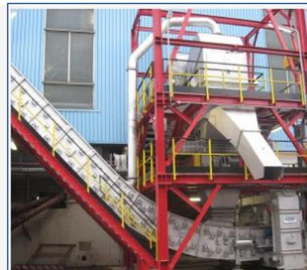
Convoyeur à bande mécanique en acier anti-poussière pour la manutention de matériaux en vrac
