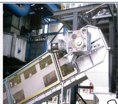
Traitement des rejets par broyeur à sec dans les centrales électriques PCF ✨
