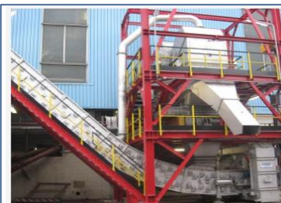
✨ Convoyeur à bande mécanique en acier anti-poussière pour la manutention de matériaux en vrac ECOBELT®
