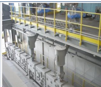
Convoyeur à bande en acier anti-poussière pour la manipulation de cendres volantes sèches ✨
